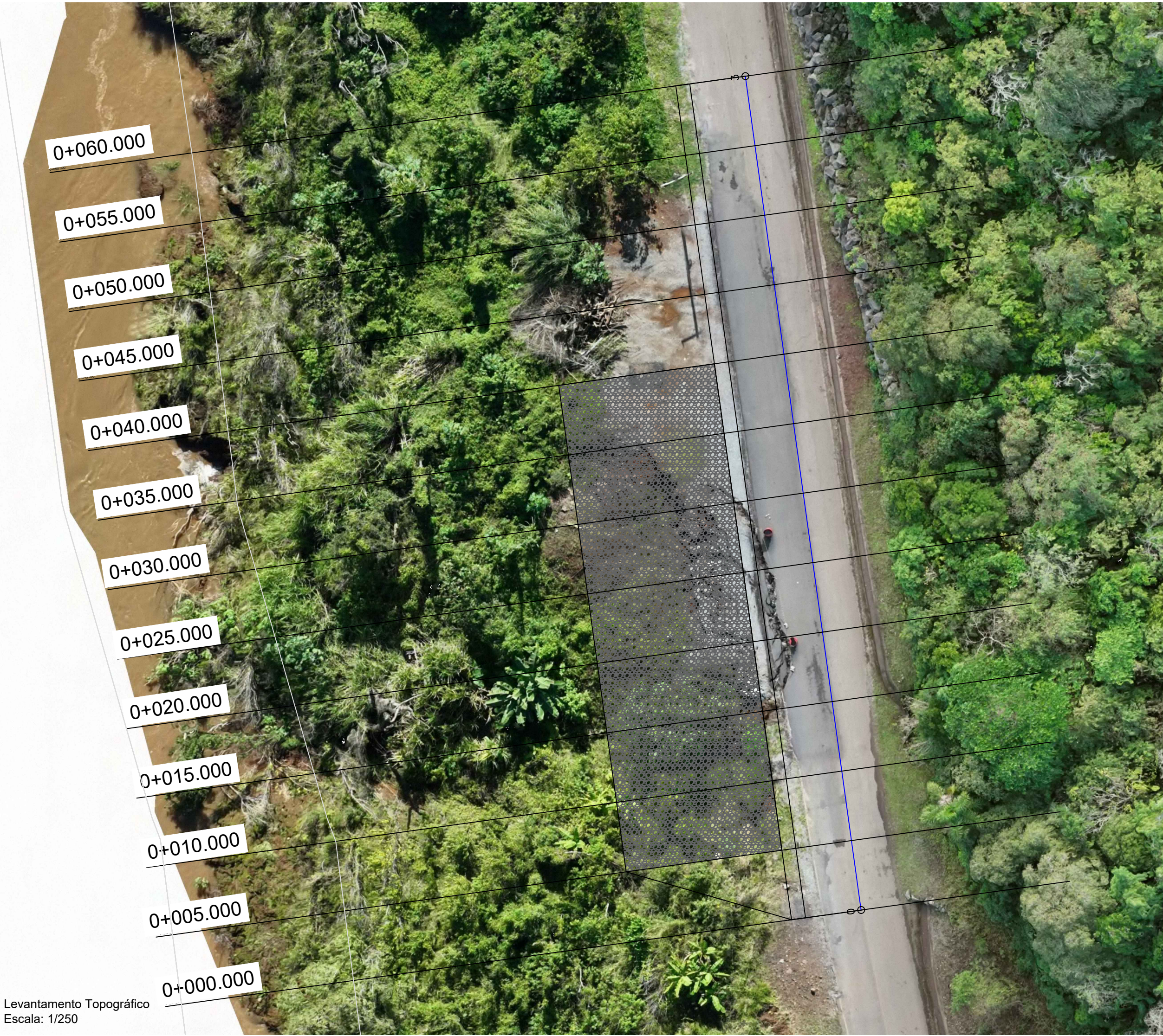
Levantamento topográfico utilizando a tecnologia LiDAR drone.
